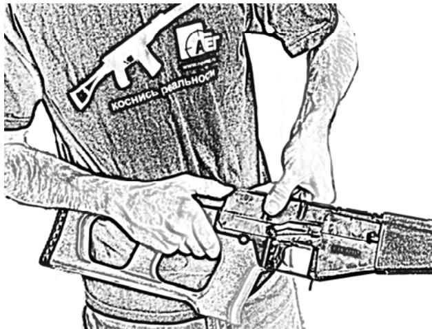
Нажать на кнопку крышки (19) и снять крышку (18)
