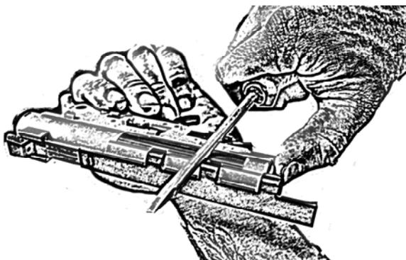
Снять с гирбокса планку соединения половинок
