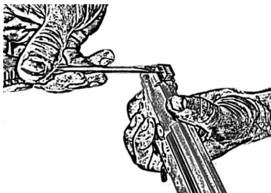
Предварительно ослабив задний соединительный винт удалить кнопку фиксации крышки ствольной коробки для АК
